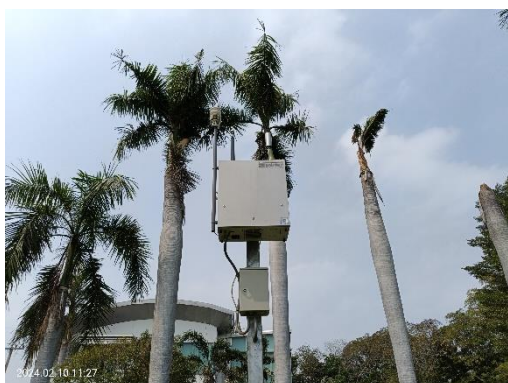
ภาพที่ 2-22 เครื่องตรวจวัดคุณภาพอากาศแบบต่อเนื่อง AQMS
